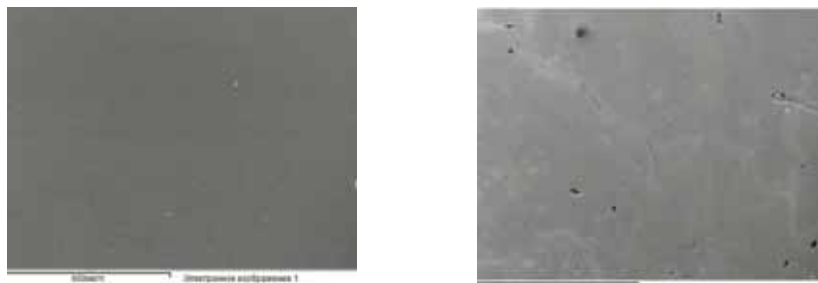
Şəkl.1. Cd 1-x Fe x Te (x=0.05) epitaksial təbəqələrinin səth morfologiyasının SEM şəkilləri: a) Dγ=0. b) Dγ=50 kQr
